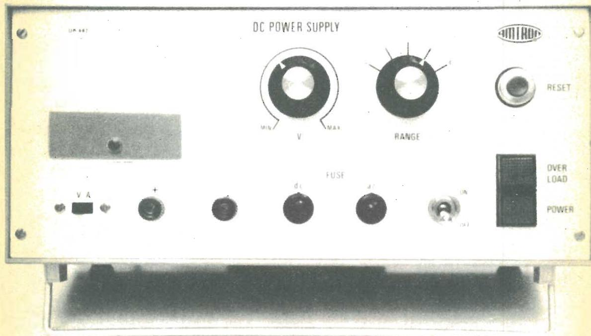
Sul pannello dell'alimentatore sono disposti tutti i comandi, compresi i fusibili per la corrente continua e quella alternata.
